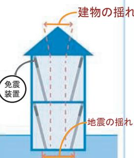
制御装置が振動を吸収する
